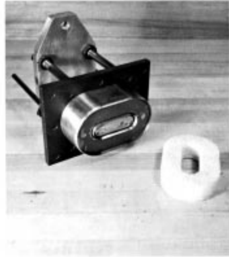
FIG. 3 Specimen Die Cutter
