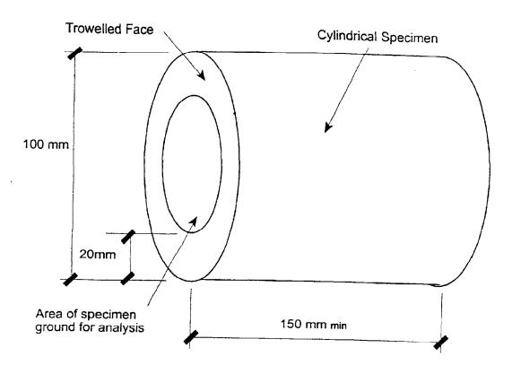
Figure 1 : Specimen dimensions
